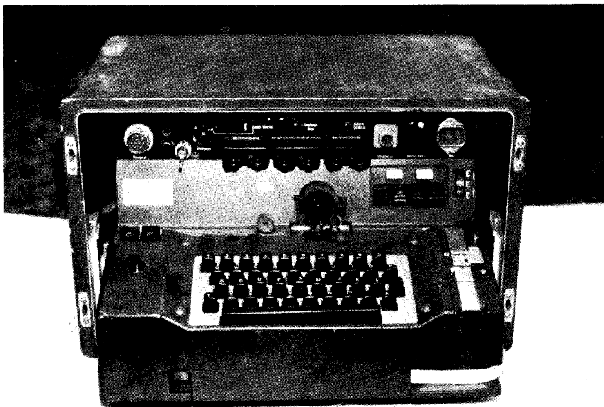
Fig. 1. De hellschrijver-80 van Siemens. Deze machine is tot ongeveer 1975 gefabriceerd. (Foto: PAoSE).
